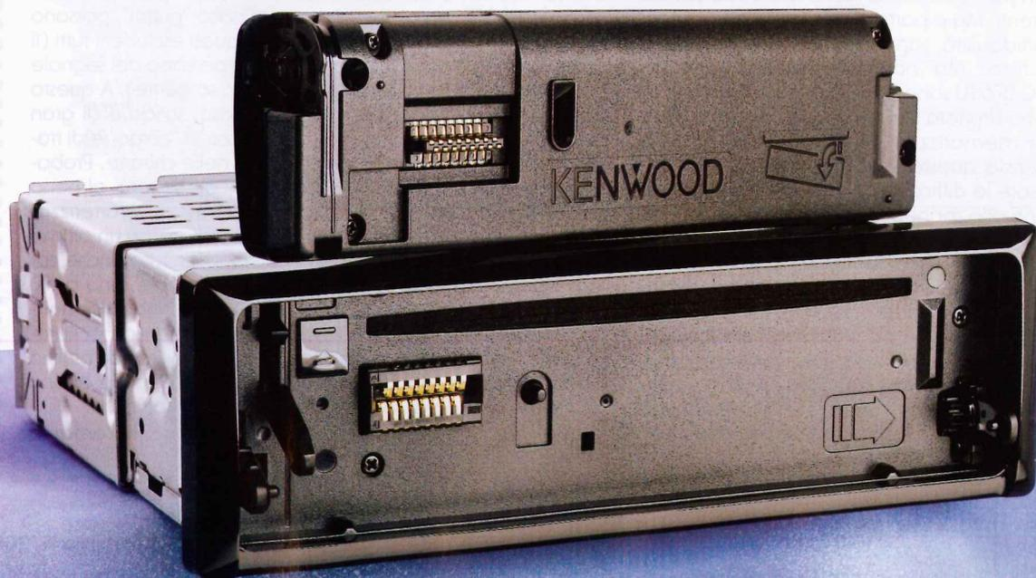
Il frontalino della KDC-BT61U si apre manualmente e scopre l'accesso allo slot della meccanica.
